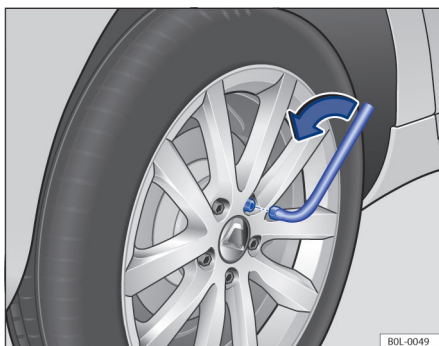
图 154 更换车轮：用车轮螺栓套筒扳手拆卸车轮螺栓
