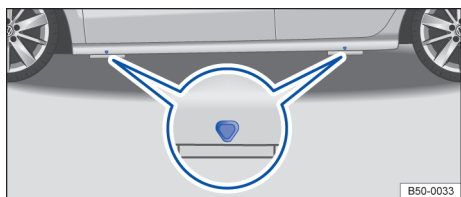
图 152 千斤顶的支撑点
