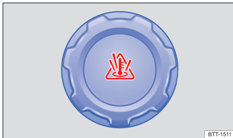
图 132 发动机舱内：发动机冷却液液罐的盖子（原理图）
