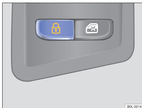
图 43 驾驶员侧车门：中央门锁按钮
